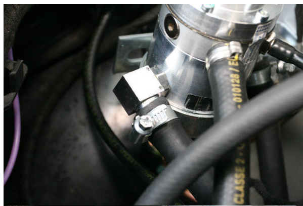
podłączenie reduktora. Wszystkie węże gumowe należy zamocować na króćcach za pomocą metalowych opasek zaciskowych
