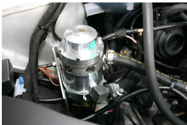
wspornik reduktora, podłączenie elektryczne zaworu odcinającego
